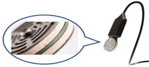
Ilustración 18: Sonda Capacitiva de tensión matricial del suelo
