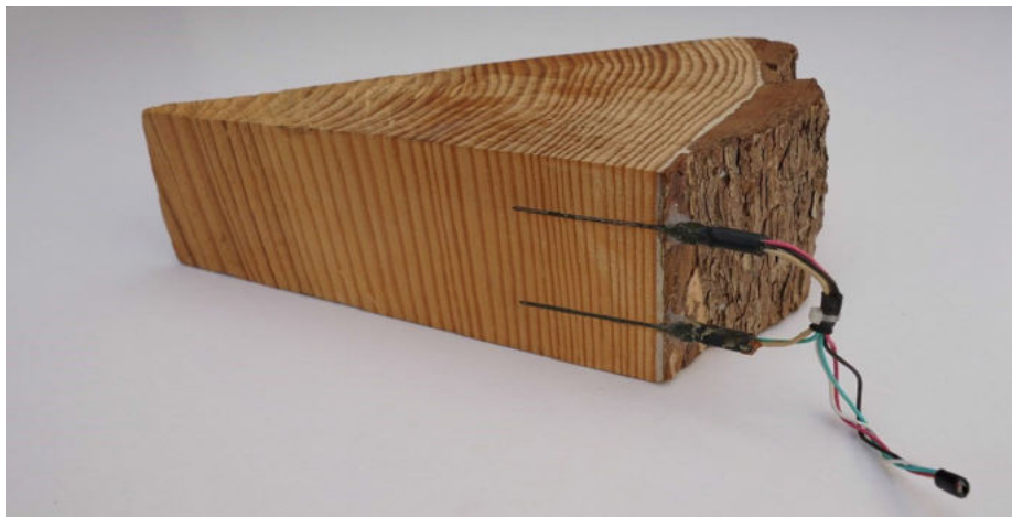
Ilustración 8: Sensores de flujo de savia. Fuente Fernando Casares Universidad de Córdoba
