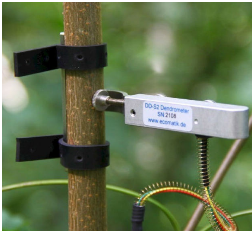
Ilustración 7: Dendrómetro. Fuente Fernando Casares Universidad de Córdoba
