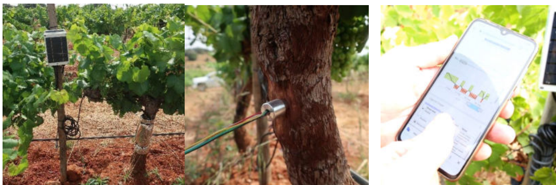
Ilustración 10: Equipo de control continuo del potencial hídrico del tallo basado en microtensiómetros instalados en el tronco de las vides
