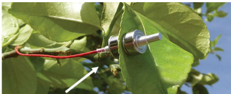
Ilustración 9: Sensor de turgencia de hoja. Fuente: Francisco Casasres Universidad de Córdoba
