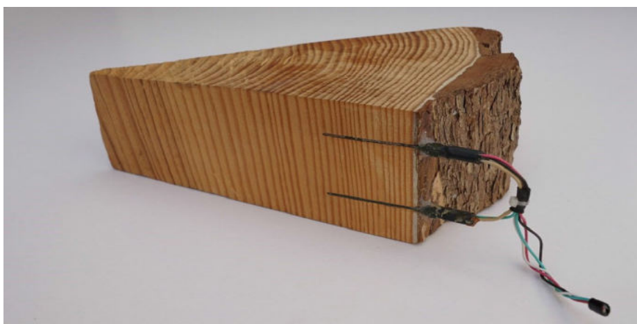
Figura 8: Sensores de fluxo de seiva. Fonte: Fernando Casares Universidade de Córdoba
