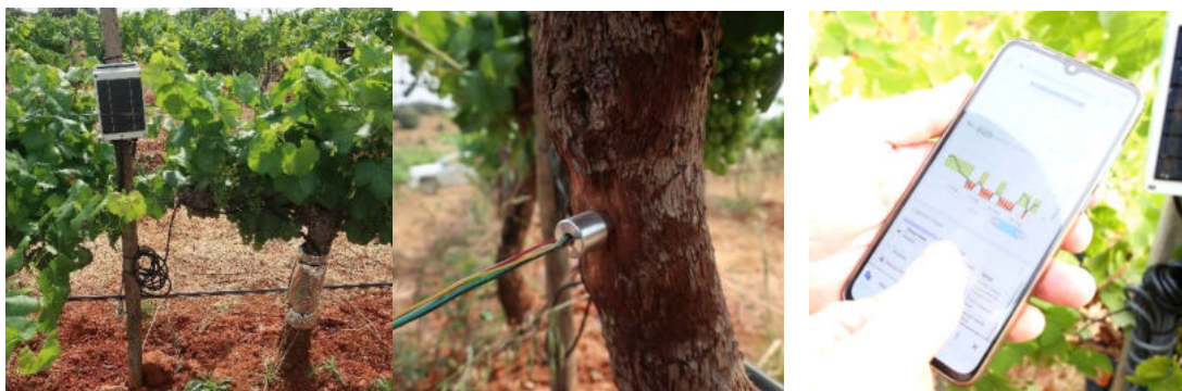
Illustration 10 : Équipement pour la surveillance continue du potentiel hydrique de la tige basé sur des microtensiomètres installés sur le tronc des vignes.
