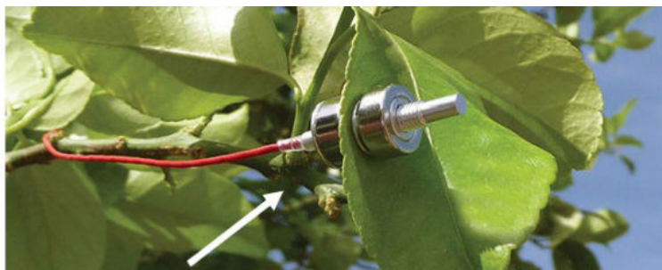
Illustration 9 : Capteur de turgescence des feuilles. Source : Francisco Casares Université de Cordoue
