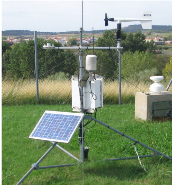
Illustration 20 : Station agroclimatique complète
