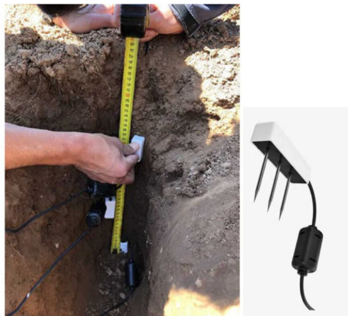
Illustration 16 : Installation de sondes d'humidité à différentes profondeurs
